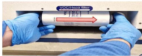
Figur 12.2 Fremgangsmåde for isætning og fjernelse af VOC/HEPA-filteret
