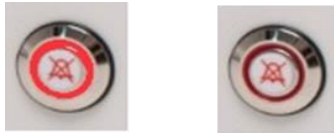
Figur 15.1 Alarmknappen, der viser alarmtilstanden
