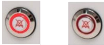
Figur 15.2 Alarmknappen, der viser alarmtilstanden
